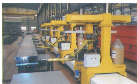
全自动双梁主梁内缝焊接机器人 Automatic welding robot for inner seam of double girder
